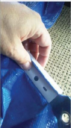
Align the Clip length with the length of the Vice. Adjust alignment if it is not correct by sliding the Clip inside the Vice. Alignez la longueur du clip avec la longueur du vice. Ajustez l'alignement s'il n'est pas correct en faisant glisser le clip à l'intérieur du vice.
