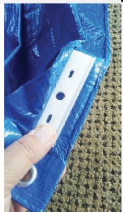
Tuck the tarp and Clip into the front inside rounded edge of the Vice using the rounded edge of the Clip as shown. Keep the cord end of the tarp out beyond the back edge of the clip. Rentrez la bâche et agrafez le bord intérieur arrondi avant du vice en utilisant le bord arrondi du clip comme indiqué. Gardez l'extrémité du cordon de la bâche au-delà du bord arrière du clip.
